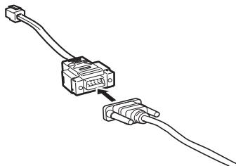
3. 本装置のコンソールポートにコンソールケーブルのRJ45プラグを差し込みます。
