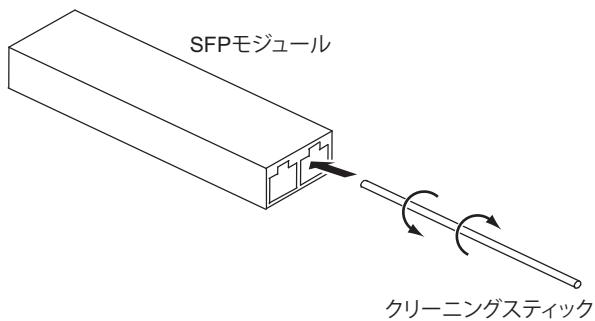
4. 新しいクリーニングスティックを挿し込み、ゆっくりと回転して乾燥させます。
