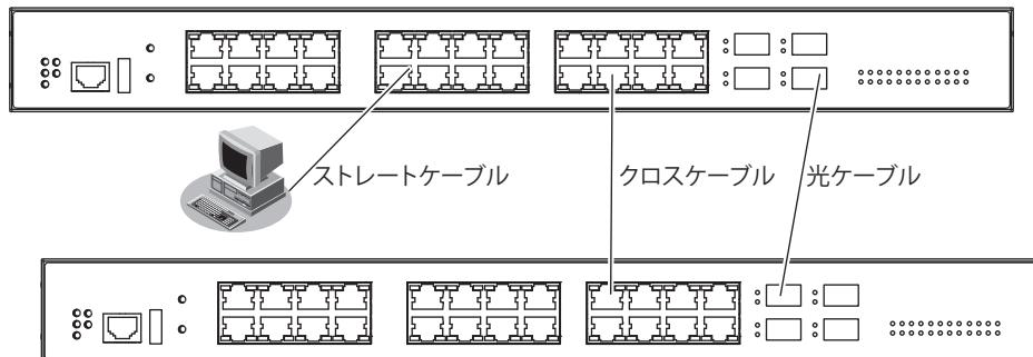
本装置の各ポートは、オートネゴシエーション機能がデフォルトでイネーブルに設定されます。オートネゴシエーションの機能により、接続された機器のサポートする最大の速度にポートが自動的に適合します。
