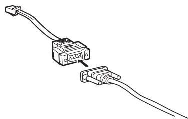
3. 本装置のコンソールポートにコンソールケーブルの RJ45 プラグを差し込みます。
