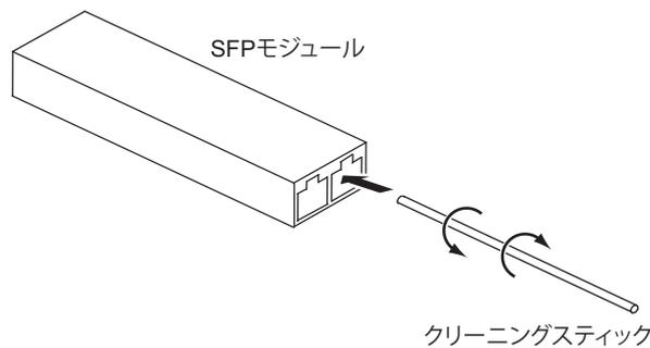
4. 新しいクリーニングスティックを挿し込み、ゆっくりと回転して乾燥させます。
