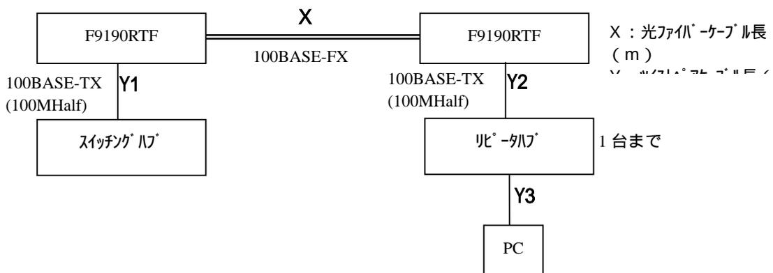
ケーブル長 :  $X + 1.2 Y \quad 170 (m) \quad (Y = Y1 + Y2 + Y3)$
