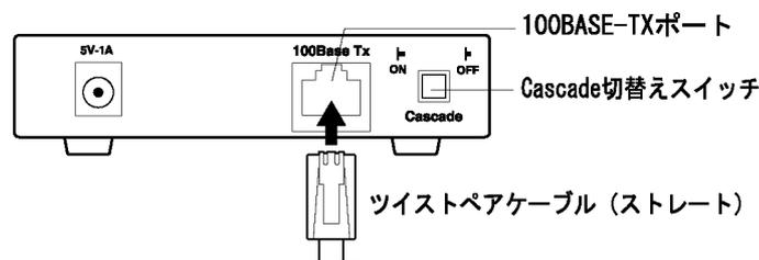
接続相手に合わせて、Cascade 切替えスイッチと 100FDX/AUTO 切替えスイッチの設定を行います。
