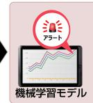
アノマリー検知(運用時) リアルタイム処理でモデルと 突合せ、「いつもの状態と違う」 状態を検知
