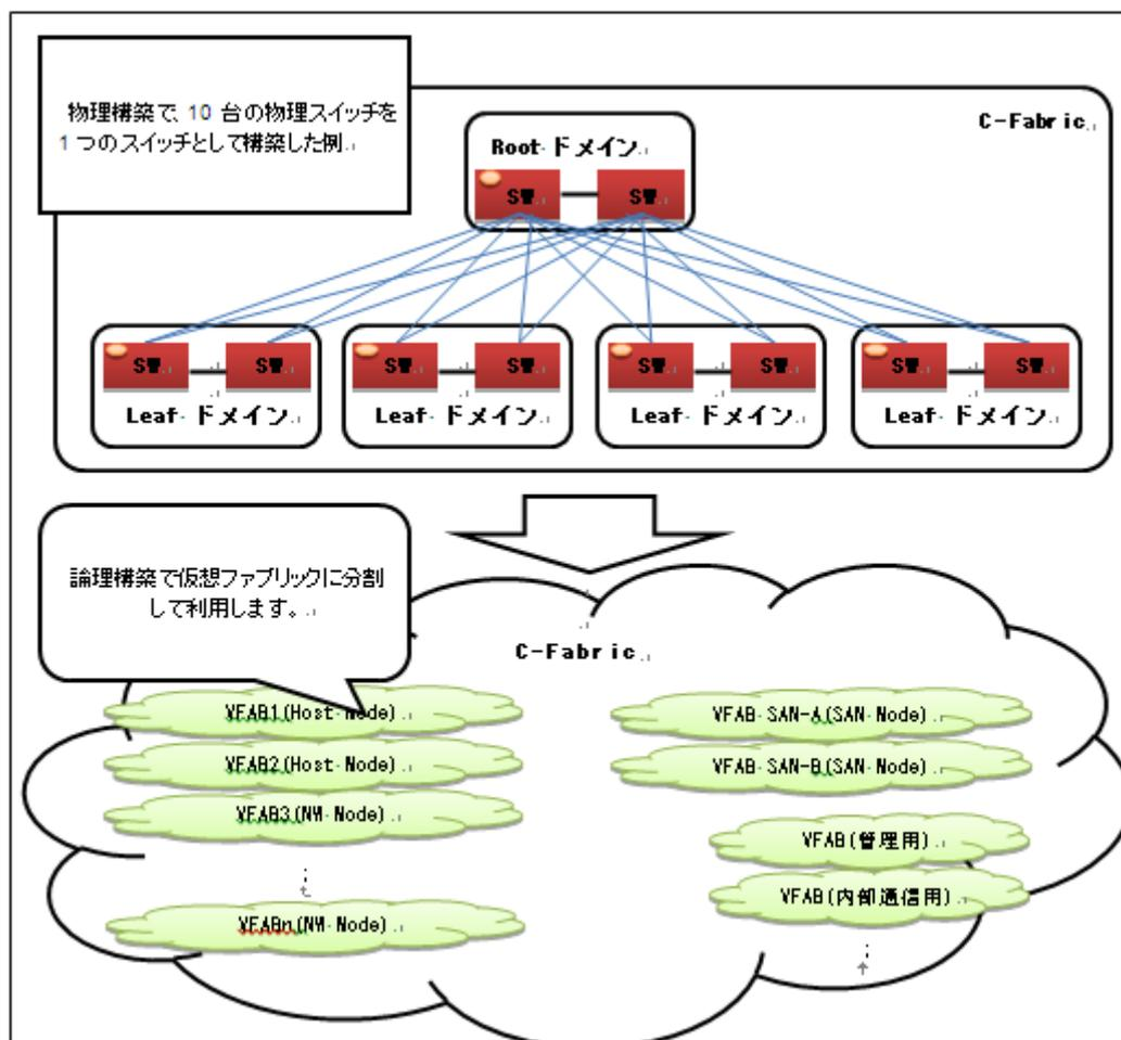
VFAB は初期設定として Default VFAB が定義されています。これは C-Fabric をマネジメントポート経由ではなく In-Band アクセス(ファブリック代表仮想 IP に SFP+/QSFP+ポートからアクセス)による管理をするために使用されます。初期値として Default VFAB はタグ無の VLAN1 で全てのポートに設定されており、全てのポートで untag の通信ができるようになっています。
