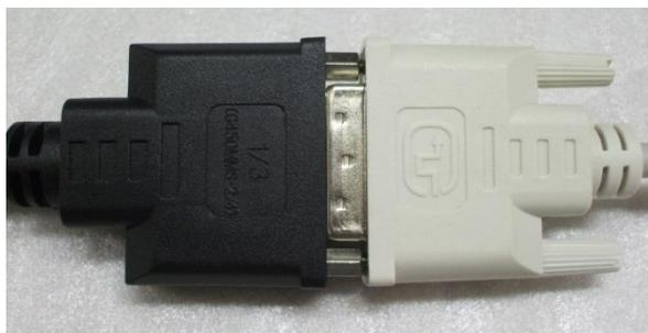
図 3-4 分岐ケーブルと DVI ケーブルの接続図
