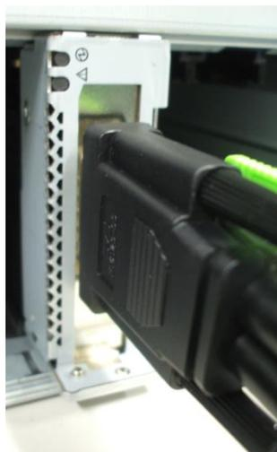
図 3-1 グラフィックスカードと分岐ケーブルの接続図
