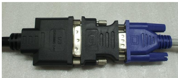
図 3-3 変換コネクタと VGA ケーブルの接続図
