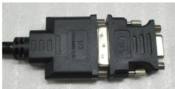
図 3-2 分岐ケーブルと変換コネクタの接続図
