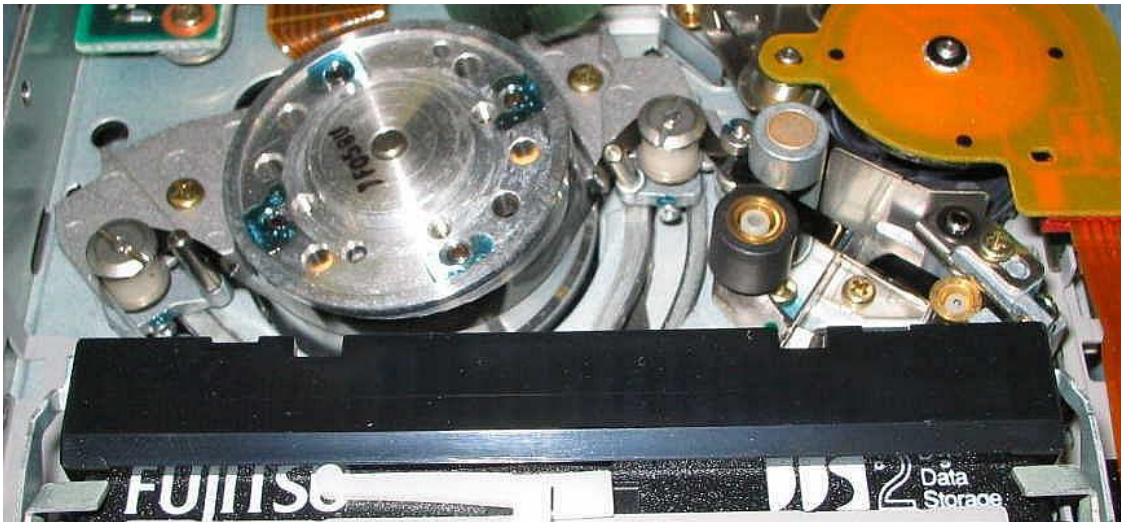
【写真8】DAT 装置の動作例。
