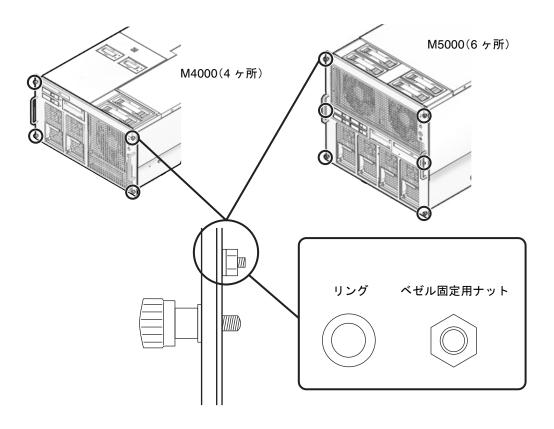
2. 外したナットとリングの代わりに、ラックキットに添付されているEリングを取り付 けます。
