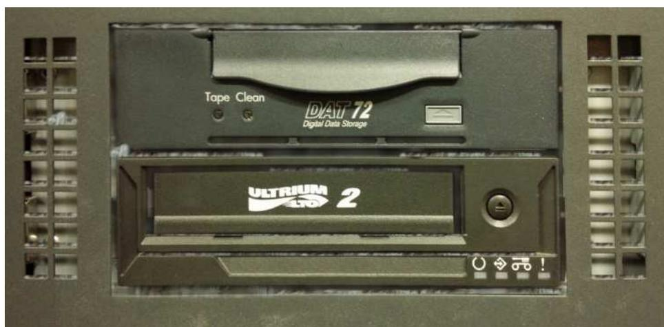
装置前面の隙間にホコリが付着している例
