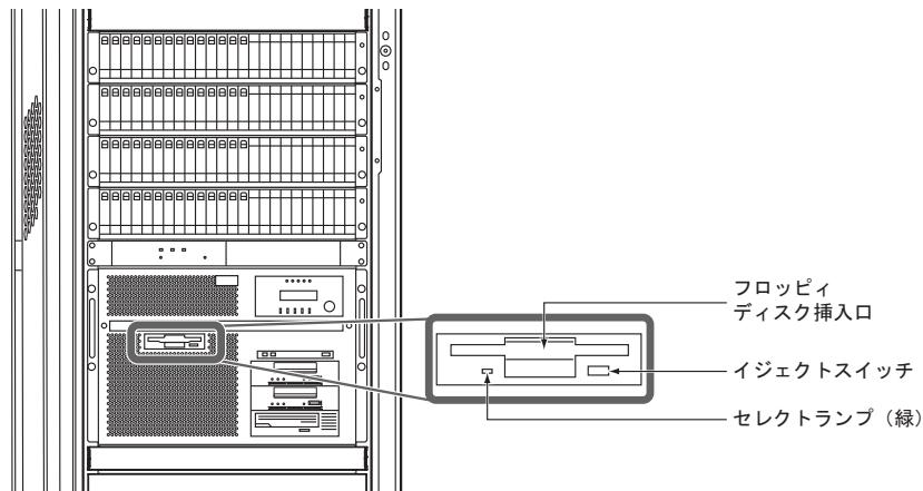
図13 フロッピィディスク装置の各部の名称
