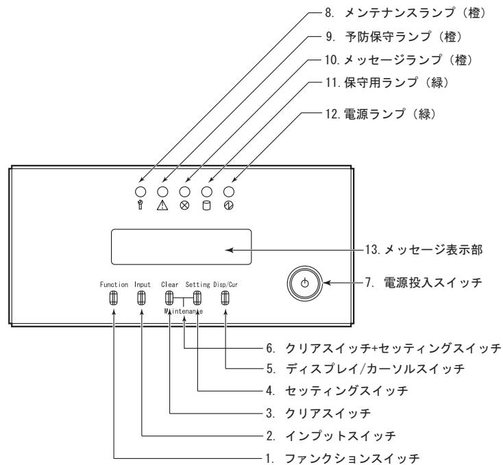
図 21 オペレーターパネルの各部の名称
