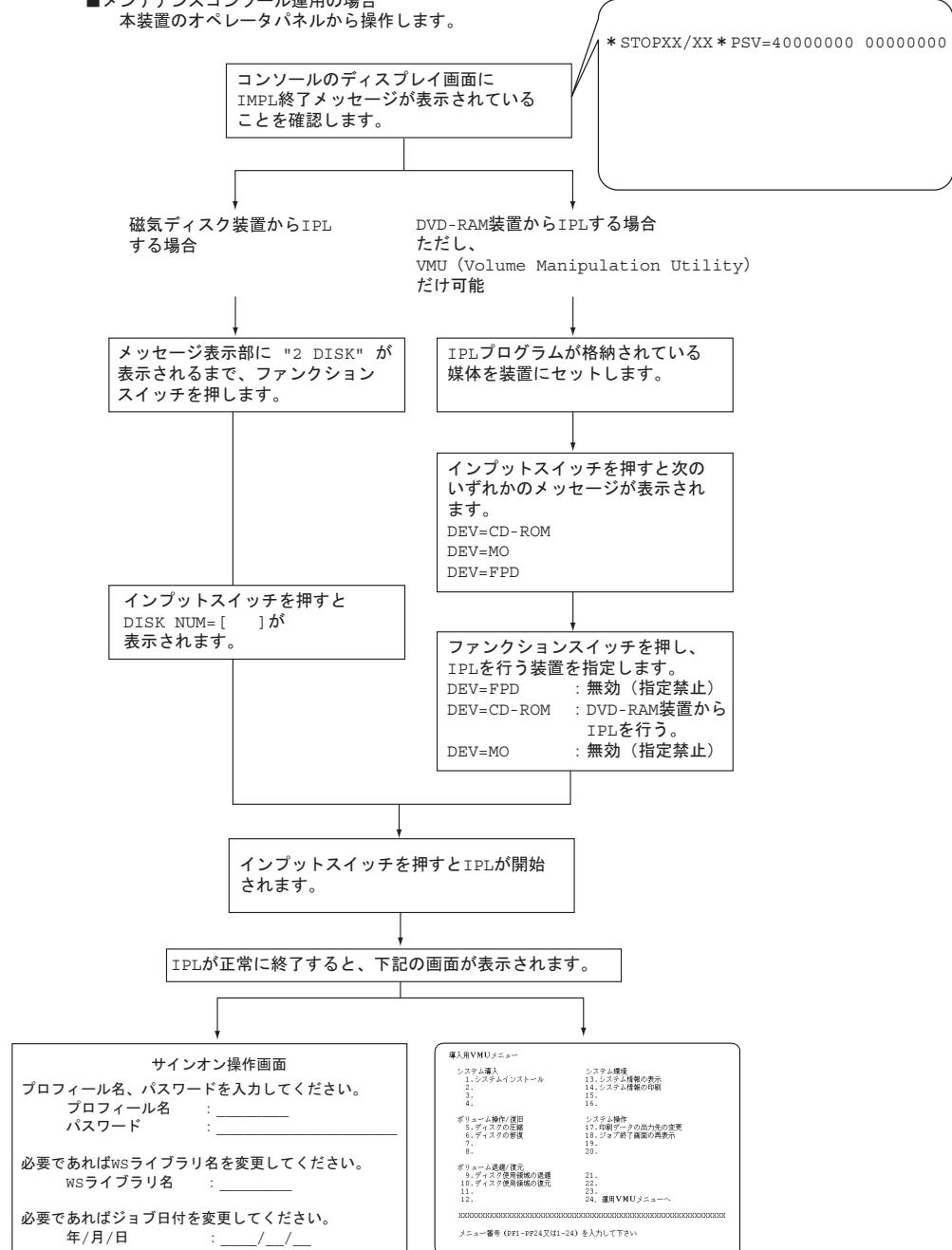
図 25 IPL 操作の流れ（メンテナンスコンソール運用の場合）
