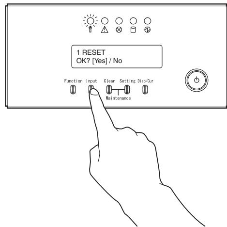
**12** クリアスイッチ+セッティングスイッチを同時に押し下し、メンテナンスランプが消灯するのを確認してください。
