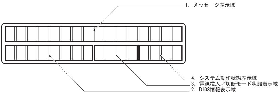
図22 オペレーターパネルのメッセージ表示部
