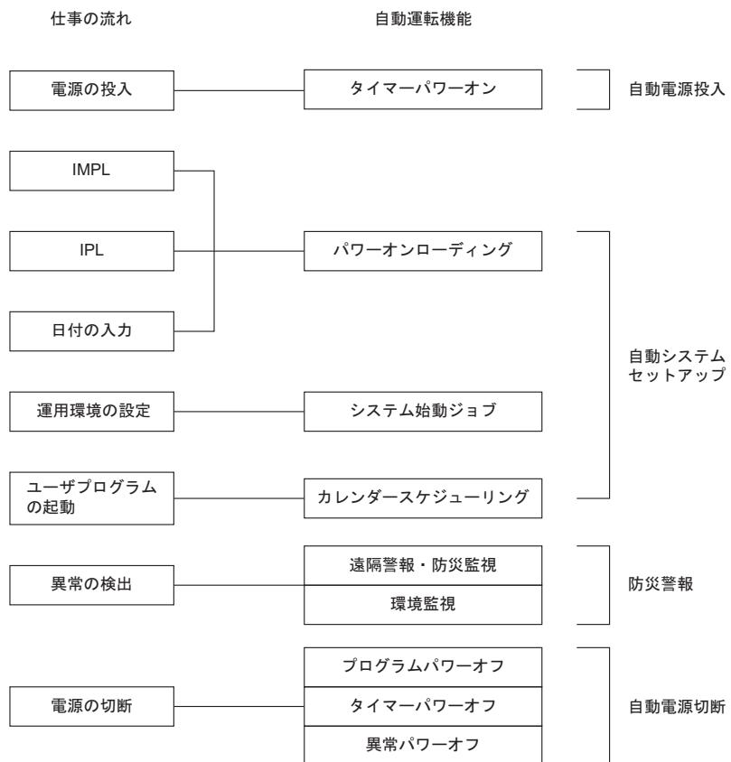
図 28 仕事の流れと自動運転機能
