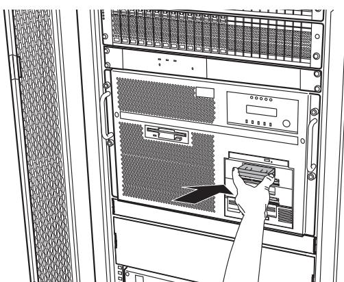
**3 データカートリッジを途中まで挿入すると装置は自動的にデータカートリッジを内部へ取り込み、ローディングを行います。約 35 秒で READY ランプが点滅から点灯に変わり、ローディングが完了します。**
