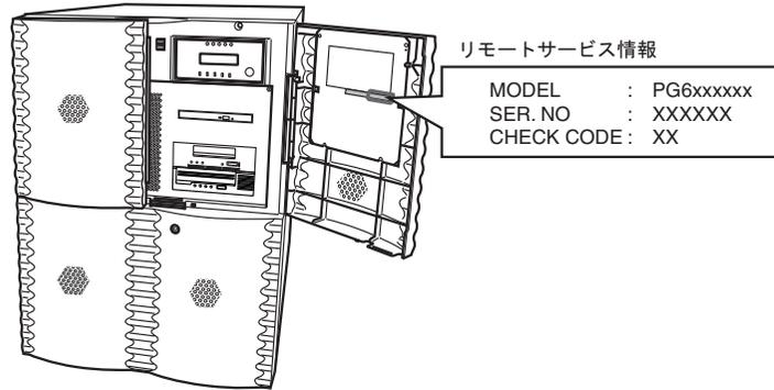
図3 装置情報ラベル (ペディスタルモデル)
