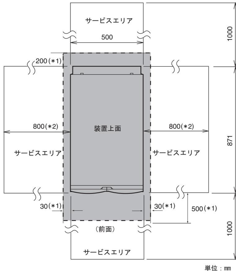
図 7 レイアウト条件 (ペディスタルモデル)
