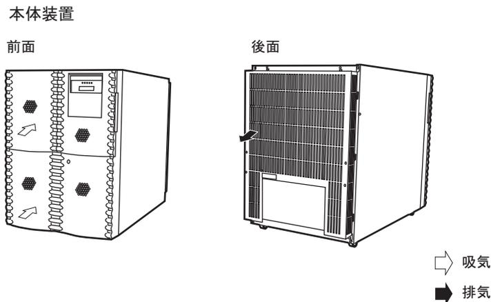
図 8 装置の吸排気（ペディスタルモデル）
