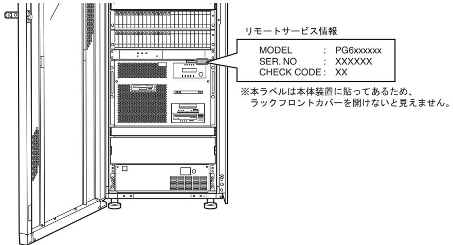
図4 装置情報ラベル (ラックマウントモデル)
