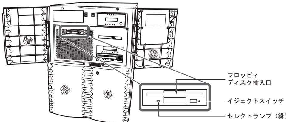
図9 フロッピーディスク装置の各部の名称
