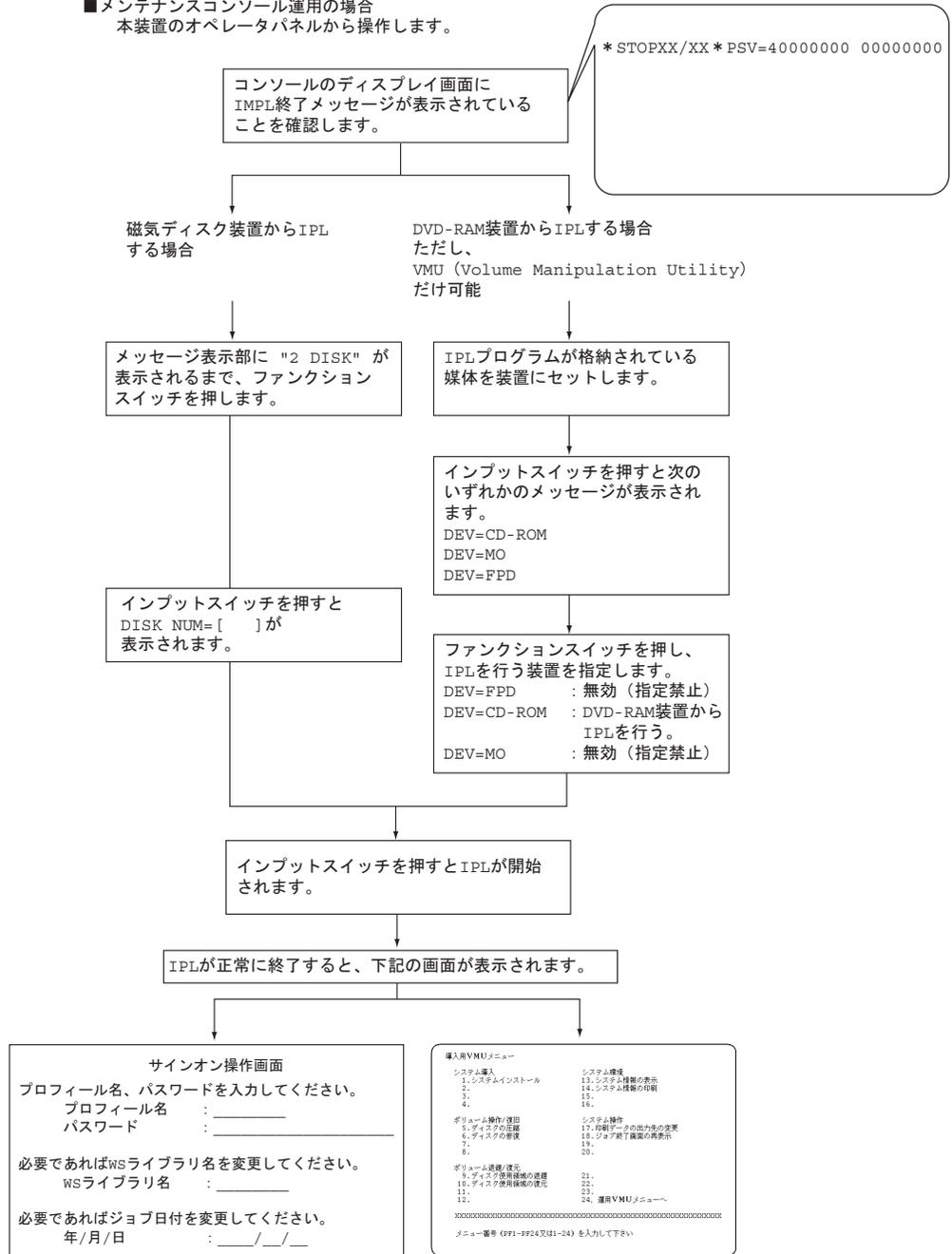
図 31 IPL 操作の流れ (メンテナンスコンソール運用の場合)
