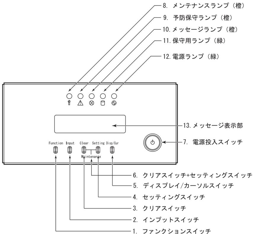
図 27 オペレーターパネルの各部の名称
