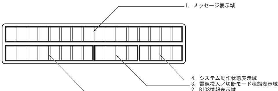
図 28 オペレーターパネルのメッセージ表示部
