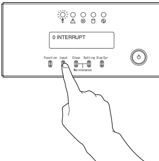
**4** 数分待った後、メッセージ表示部に "X 0100" が表示されていることを確認します。表示されない場合、メモリダンプの出力に失敗しています。
