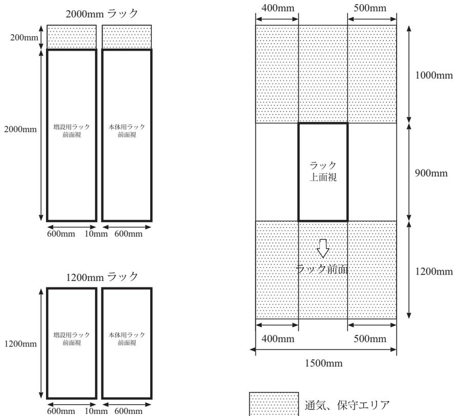
図 23 レイアウト条件 (ラックマウントモデル)
