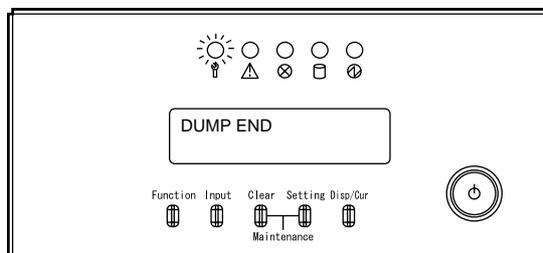
9 システムを再起動します。メッセージ表示部に"1 RESET"が表示されるまで、ファンクションスイッチを押します。
