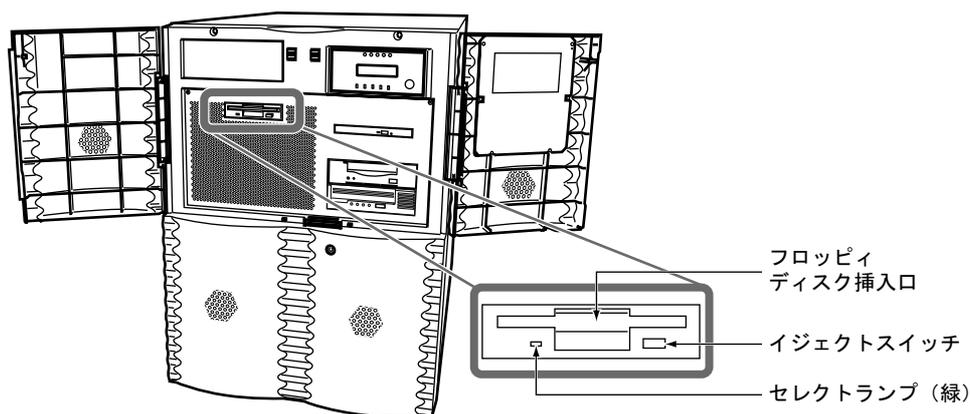
図 4.4 フロッピーディスク装置の各部の名称
