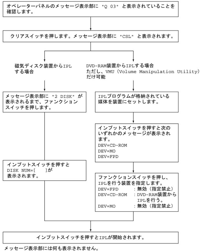
付図 C.4 IPL 操作の流れ (LAN 型コンソール運用の場合)
