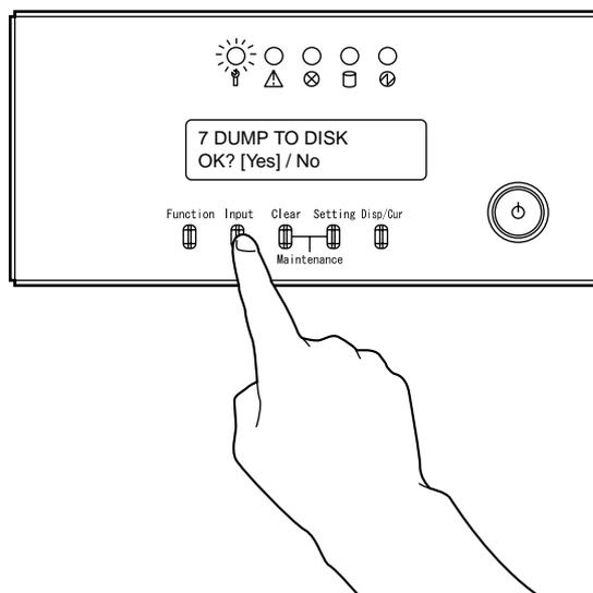
7 インプットスイッチを押します。メッセージ表示部に"DUMP START"と表示されます。
