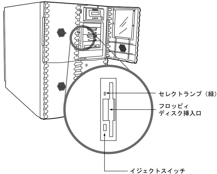
図 4.3 フロッピーディスク装置の各部の名称
