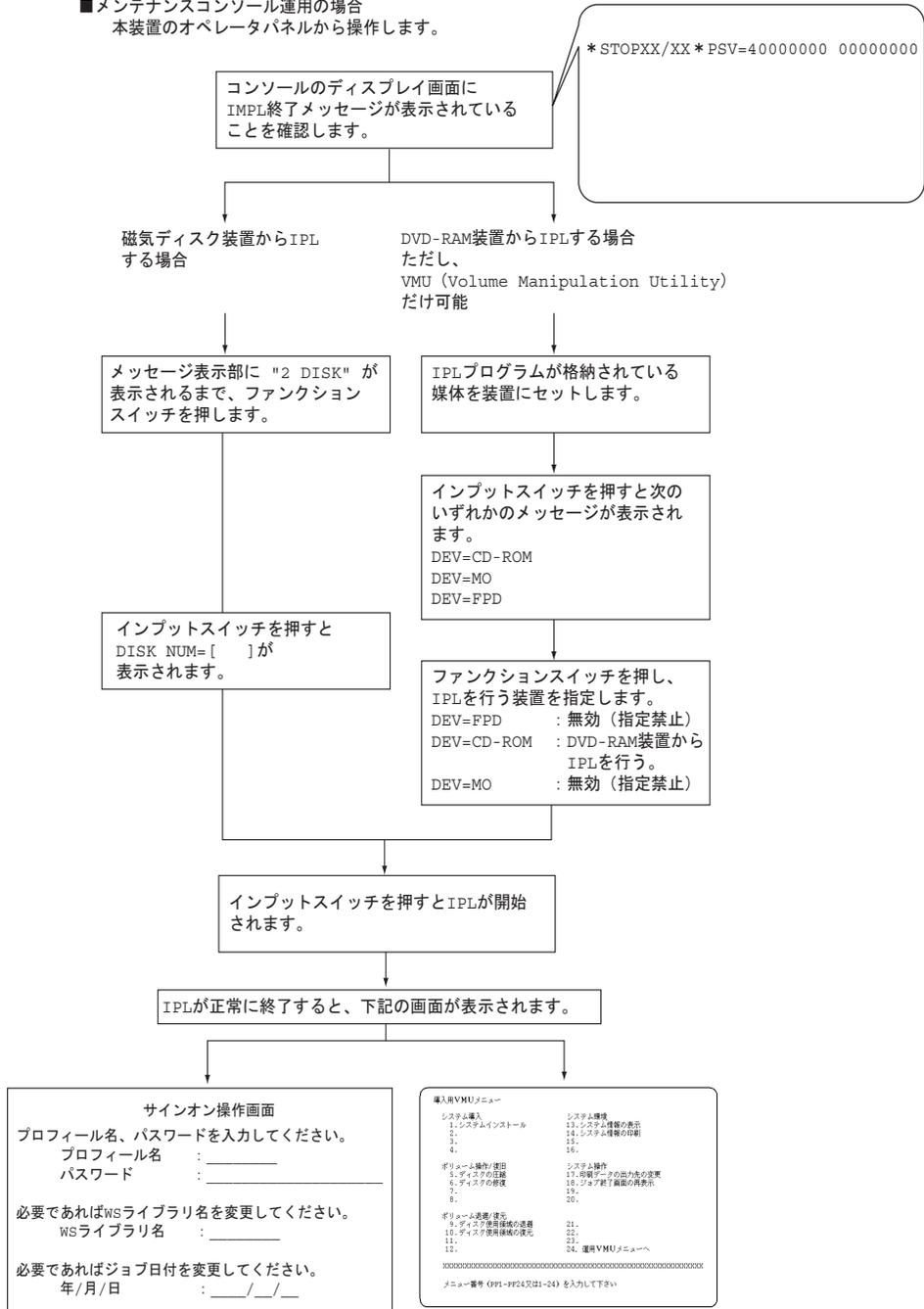
図 15 IPL 操作の流れ (メンテナンスコンソール運用の場合)
