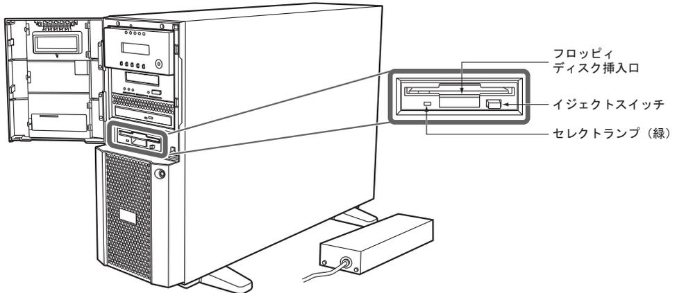
図7 フロッピーディスク装置の各部の名称
