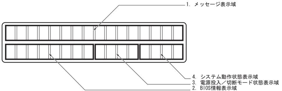
図 12 オペレーターパネルのメッセージ表示部
