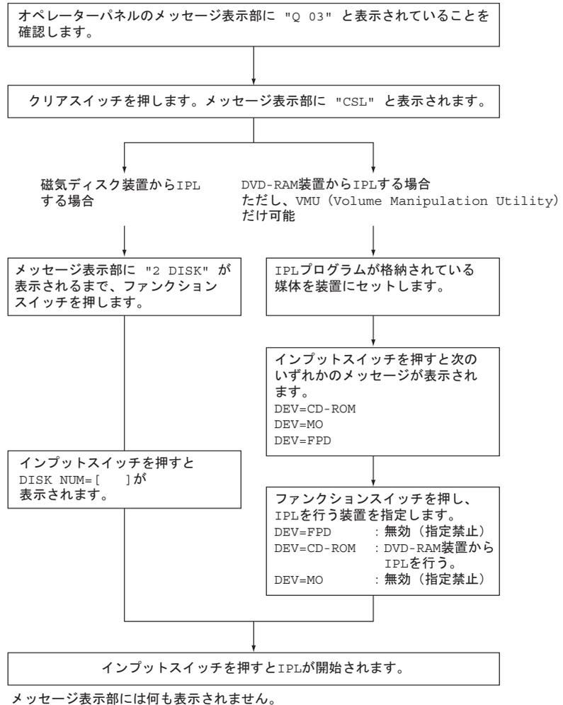
図 16 IPL 操作の流れ (LAN 型コンソール運用の場合)
