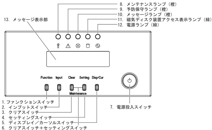
図 11 オペレーターパネルの各部の名称
