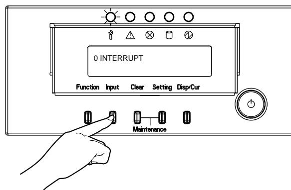
4 数分待った後、メッセージ表示部に"X 0100"が表示されていることを確認します。表示されない場合、メモリダンプの出力に失敗しています。
