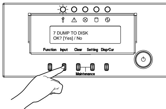
7 インプットスイッチを押します。メッセージ表示部に"DUMP START"と表示されます。
