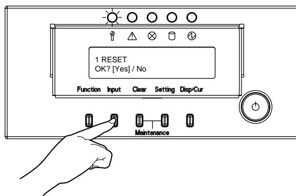
12 クリアスイッチ + セッティングスイッチを同時に押下し、メンテナンスランプが消灯するのを確認してください。
