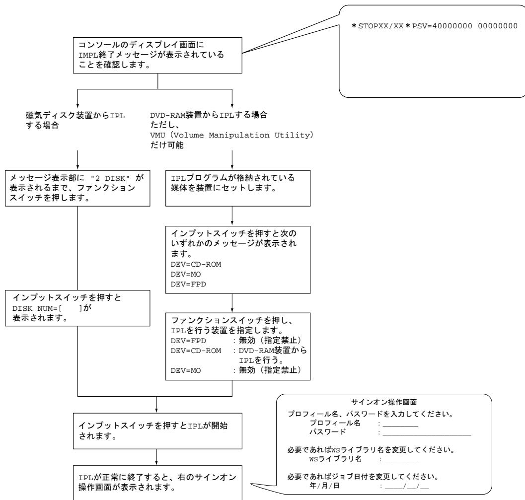
付図 C.3 IPL 操作の流れ(メンテナンスコンソール運用の場合)
