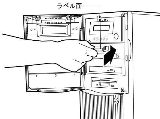
3 データカートリッジを止まるまで挿入すると装置は自動的にロードが開始されます。
