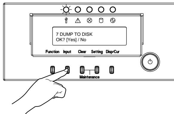
4 インプットスイッチを押します。メッセージ表示部に"DUMP START"と表示されます。
