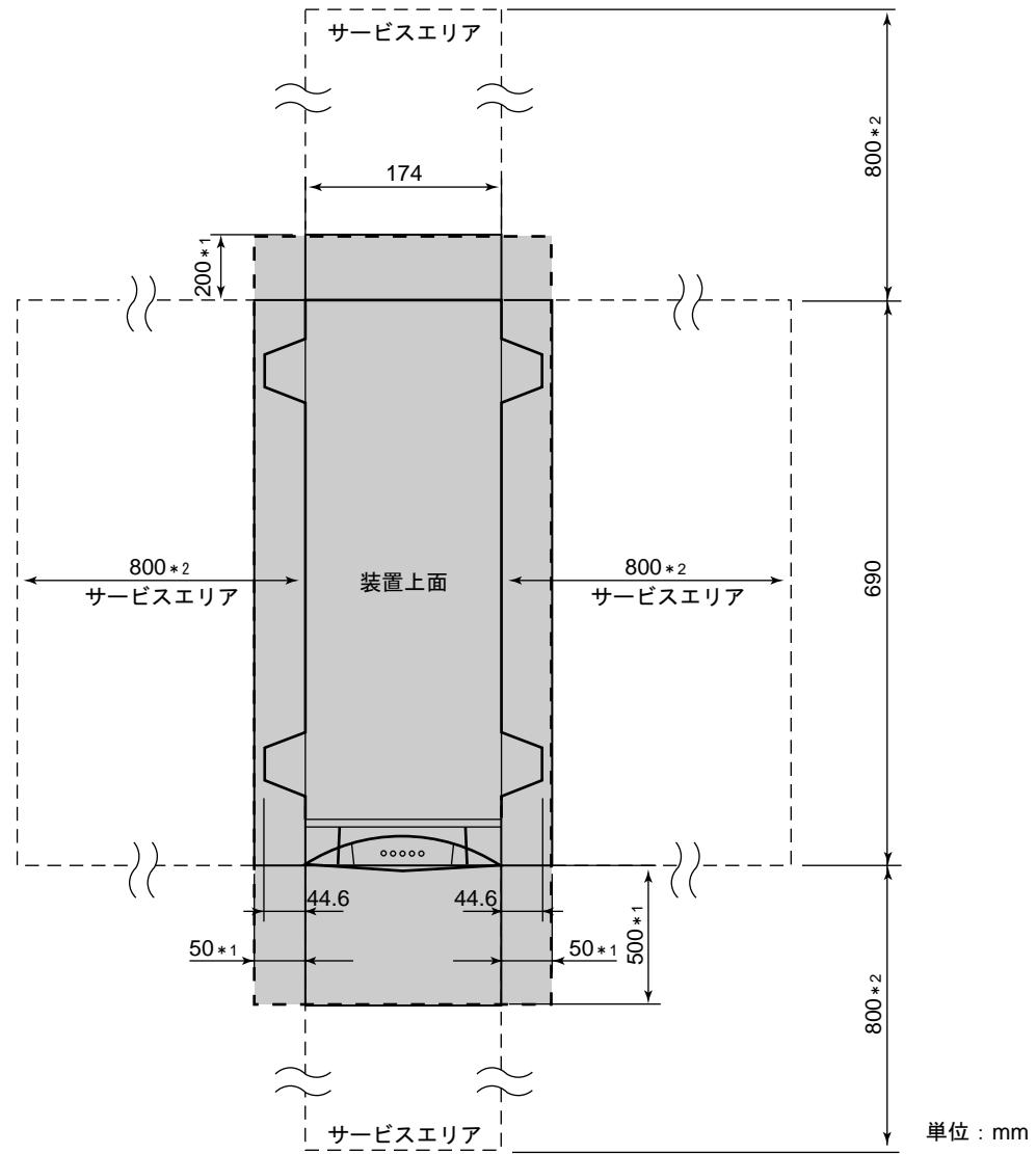
\*1 装置内部を冷却(空冷)し、故障を防止するため、および日常の操作と十分な冷却のために必要なエリアです。必ず確保してください。
