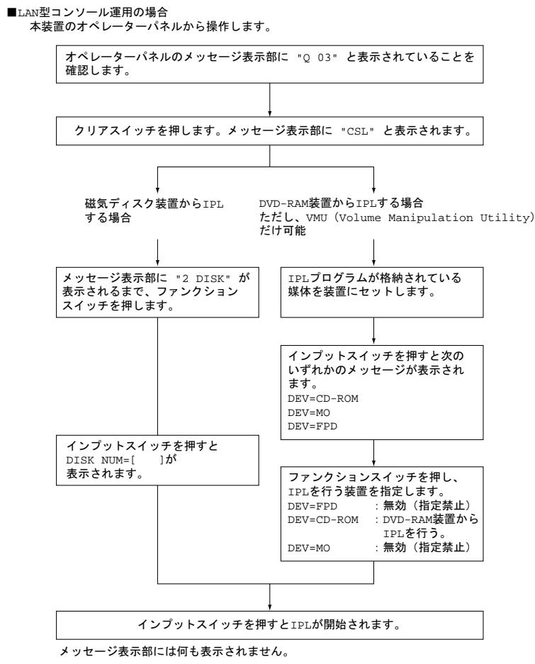
付図 C.4 IPL 操作の流れ ( LAN 型コンソール運用の場合 )
