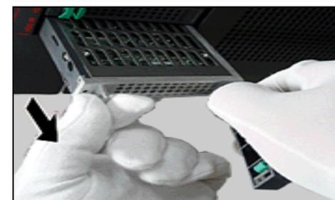
緑色のHDDのフック部を押し、レバーを引いて開いたあと、レバーを持って、ドライブを引き出します。
