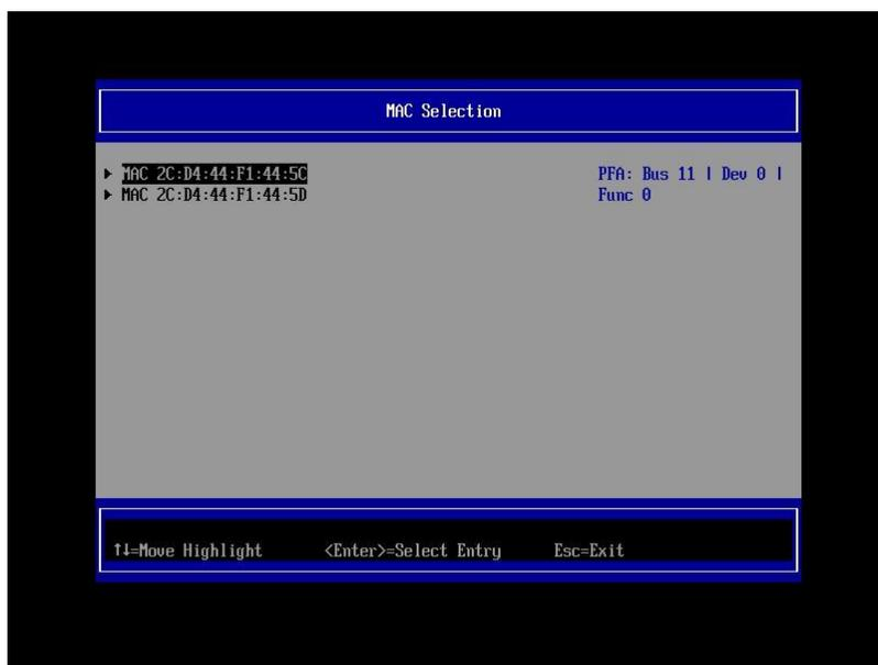
4. 設定するポート (MAC アドレス) を選択すると、[Attempt Configuration] 画面が表示されます。Attempt Configuration メニューでは、選択したポートに iSCSI Boot およびインターネット プロトコル (IP) パラメーターを設定できます。
