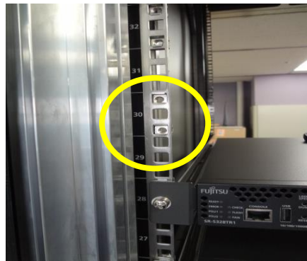
[サイドフレームにM5 ケージナットをセット]
