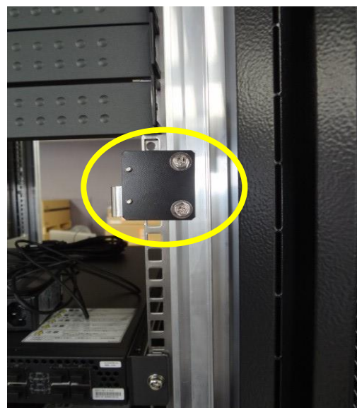
[M5 ネジでヒンジを取り付け]
