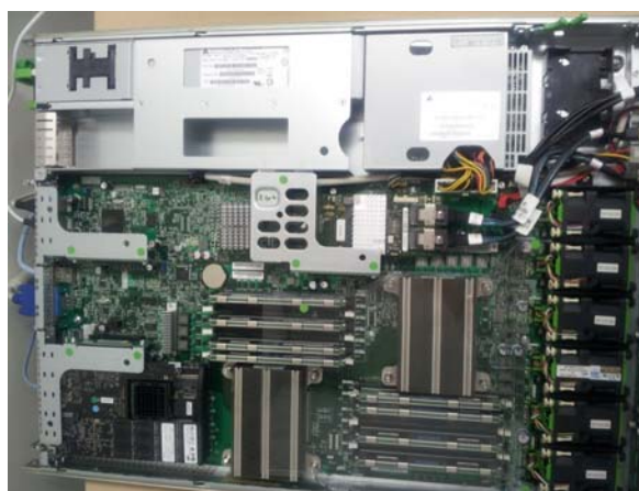
写真 2 : ioDrive Duo 装着状態 (全体)
