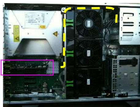
写真 2 : ioDrive Duo 装着状態 (システム側面)
