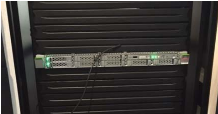
図 4.1.1 SPARC M10-1 サーバの本体を取付けたときの正面写真
