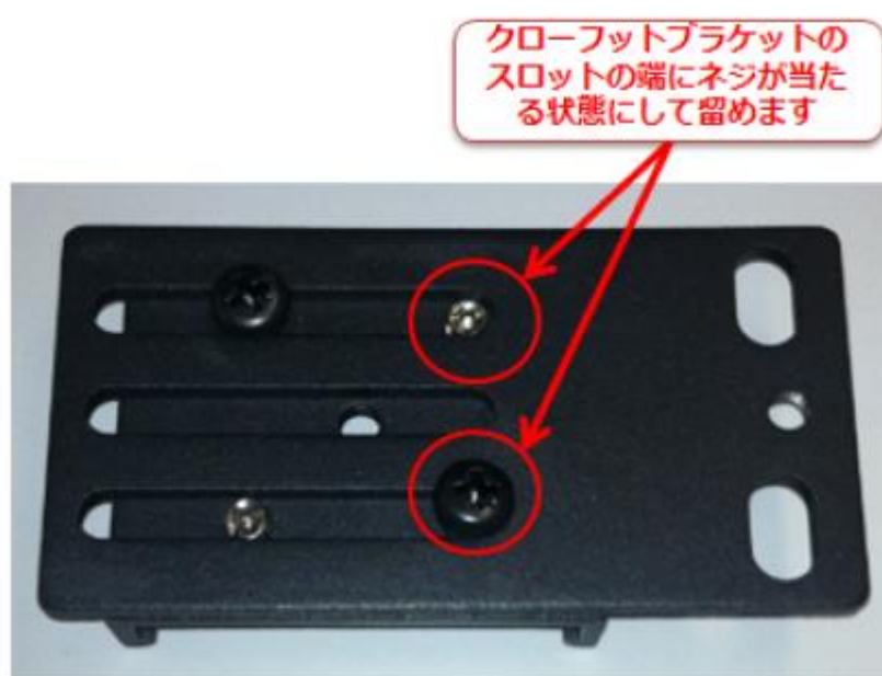
図 4-④. ベースプレートとクローフットブラケットの固定位置
