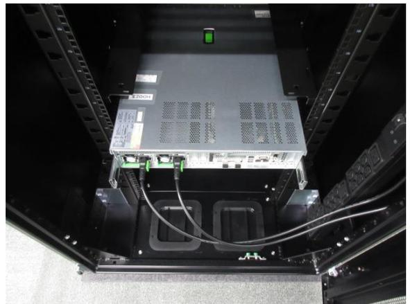
【検証結果】上記項目の確認を行い、PRIMERGY RX2540 M4 搭載確認、ラック内前面スペース、背面側配線スペースが十分確保されていることを確認しました。
