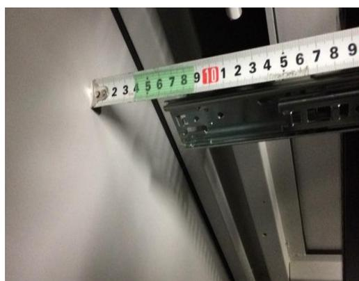
(ウ) SPARC M10-1 用レールキット搭載後の PDU 搭載の確認検証
