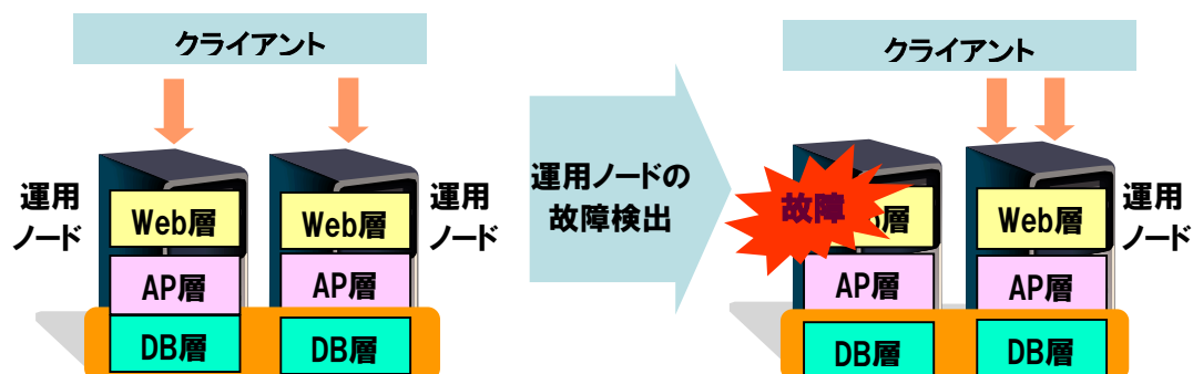
(2) 「DBC/APKeeper+DB/Control」による両系運用のノード構成
