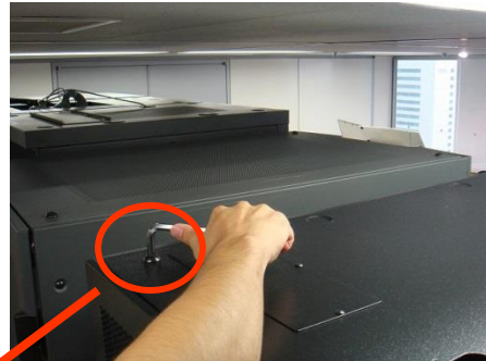
2) トップカバーを留めているボルトを外す。 ※後扉側左右1カ所ずつ(計2カ所)
