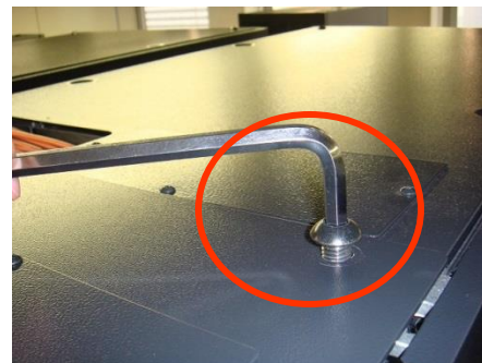
6) 後扉側左右1カ所ずつボルトで固定する。 (計2カ所) ※2) で取り外したボルト(2個)を使用します。
