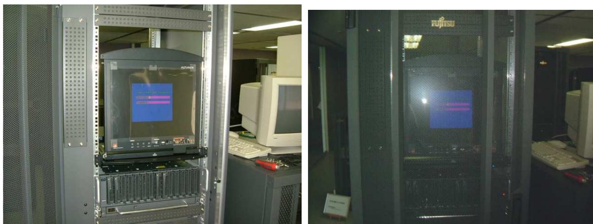
KLシリーズの特徴としてLCD部分とキーボード部分を別々に引き出せるデュアルスライドがあります。例えばLCD部分のみ引き出しLCDを立てた状態でラックの扉(要ガラス張り等)を閉めてもモニタリング可能になります。
