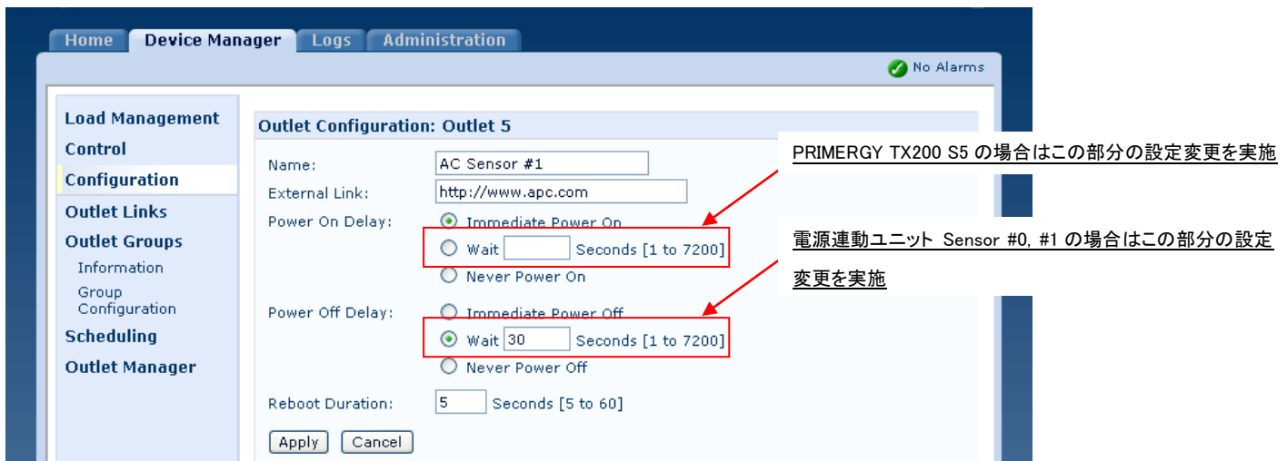
図6. Switched Rack Mount PDU デバイスマネージャ Outlet Configuration 画面詳細
