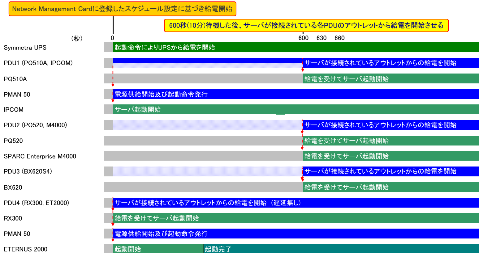
図27. スケジュール設定に基づく起動【パターン3】
