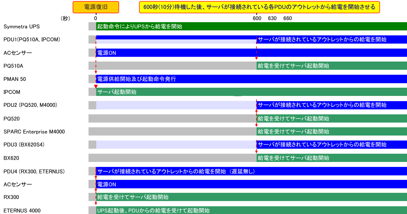
図12. 電源復旧時の動作【パターン4】
