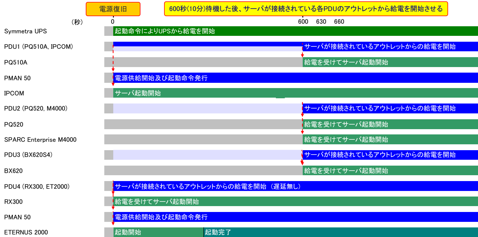
図10. 電源復旧時の動作【パターン3】
