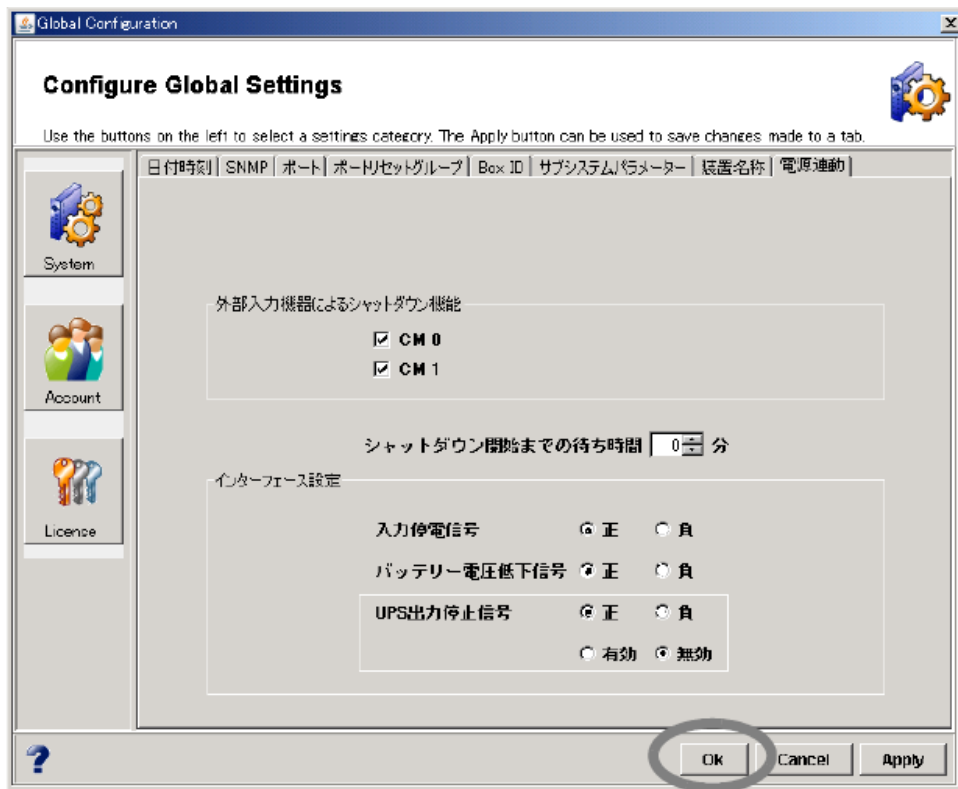
図4. ETERNUSmgr の「Configure Global Settings」→「電源連動」の画面(例) (ETERNUS2000 のコントローラ CM#0、CM#1 の両方で制御する場合の設定)
