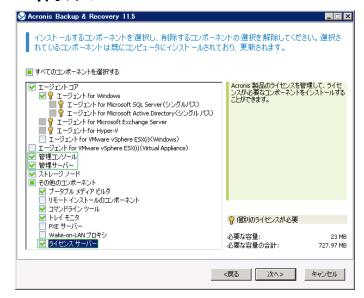
PRIMERGY RX350 S7 (Windows Server 2008R2)構成 管理サーバ、ライセンス サーバ、ストレージ ノードのABR11.5コンポーネ ントを追加でインストールします。
