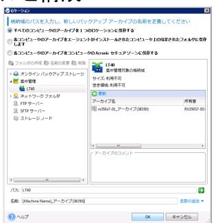
集中管理の格納域としてテープデバイスを使用する場合、[ストレージノード]コンポーネントがインストールされたWindowsコンピュータにデバイスを事前に接続する必要があります。
