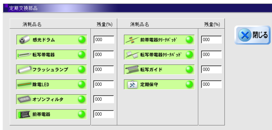
図 2.47 定期交換部品
