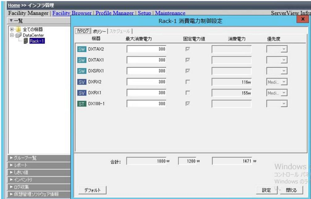
13. [設定] ボタンをクリックすると、設定処理が実行されます。処理が終了したら[閉じる] ボタンをクリックして[消費電力制御設定] 画面を閉じます。
