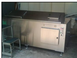
生ごみ処理装置
