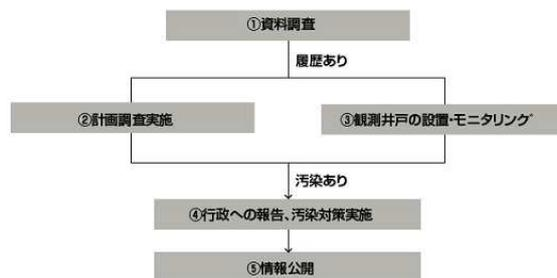
\*土壌・地下水汚染の最大のリスクである、地下水による汚染の敷地外への影響を監視
