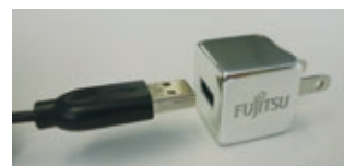
窒化ガリウム(GaN-HEMT) ACアダプター
