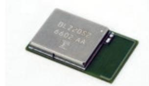
無線モジュールFWM7BLZ20シリーズは、Bluetooth version 4.2(注)に対応した小型無線モジュールです。高い処理能力・低消費電力のプロセッサを内蔵した無線通信LSIを採用し、既存製品と同じサイズでありながらエネルギーマネジメント機能を最適化することで、消費電力は約2分の1の約5.4mA(実測値)、受信感度は-94dBm(実測値)と、約2倍の通信距離を実現しました。さらに、処理能力の向上により、従来はサーバで行っていたセンサーなどのデータ解析をモジュール内で実行できるようになったため、ネットワークへの負荷を低減させシステムの省エネ化に貢献します。また、製品の内部構成を見直し、既存製品と同等のアンテナ特性を維持しながら軽量化を図ることで、18%の省資源化を達成しました。
