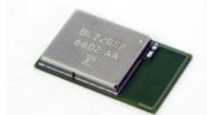
無線モジュールFWM7BLZ20シリーズは、Bluetooth version 4.2(注)に対応した小型無線モジュールです。高い処理能力・低消費電力のプロセッサを内蔵した無線通信LSIを採用し、既存製品と同じサイズでありながらエネルギーマネジメント機能を最適化することで、消費電力は約2分の1の約5.4mA(実測値)、受信感度は-94dBm(実測値)と、約2倍の通信距離を実現しました。さらに、処理能力の向上により、従来はサーバで行っていたセンサーなどのデータ解析をモジュール内で実行できるようになったため、ネットワークへの負荷を低減させシステムの省エネ化に貢献します。また、製品の内部構成を見直し、既存製品と同等のアンテナ特性を維持しながら軽量化を図ることで、18%の省資源化を達成しました。
