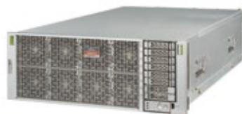
プロセッサの性能向上に伴って増加する発熱量への対応として、富士通では気化熱を利用した冷却技術「Vapor and Liquid Loop Cooling (VLLC)」を業界で初めて開発しました。2017年4月に発表した「SPARC M12シリーズ」のプロセッサ「SPARC64 XII」に適用し、従来の冷却方式と比べて約2倍の冷却効率を達成しています。現在、多くのサーバでは、プロセッサの表面に取り付けたヒートシンクをファンからの送風で冷却する「空気冷却」を採用しています。しかし、プロセッサの高性能化に従って発熱量は増大し、放熱を行うヒートシンクも大型化していました。今回開発した減圧気化冷却技術「VLLC」は、熱輸送能力の高い「水」を冷媒に使用し、しかも内部を減圧することで効率的に熱を奪うことができる「気化」現象を利用し、高い冷却性能を実現。「VLLC」によって効率的かつ集中的に冷却を行うことができ、ファンの消費電力削減に貢献しています。
