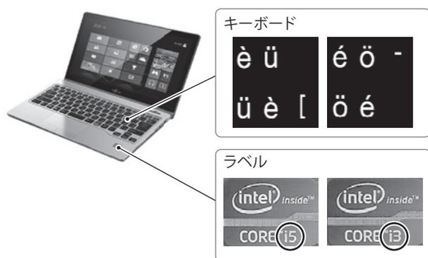
図-1 印字内容の微妙な違いに対応する外観検査
