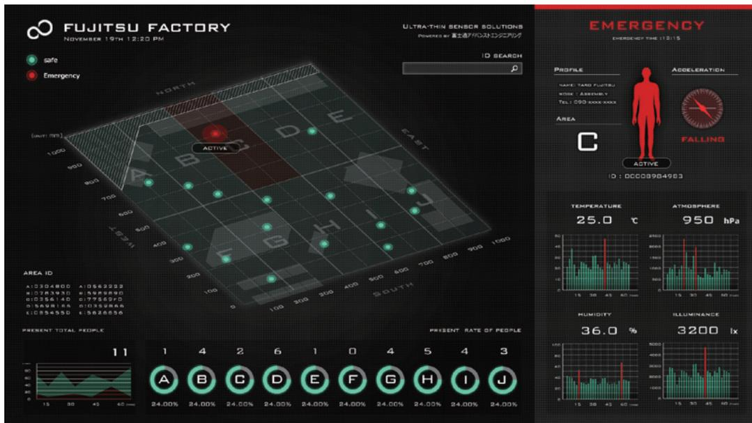
図-3 作業員転倒・事故検知 デモ画面
