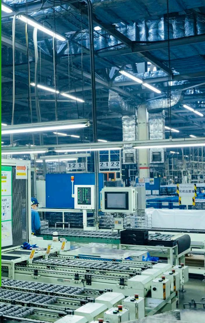
**SUBARU群馬製作所大泉工場はエンジン用カムシャフトの加工品質を検査なしに全品保証することを実現しました。富士通とともに開発した研削加工工程の品質を保証するAIモデルに、予測精度低下を防ぐ仕組みを盛り込み、量産工程での本格稼働に至りました。**
