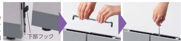
一方のパネルに下部フックを付け 上から連結金具を差し ポルト2個で固定します。て、連結するパネルを引っ掛けます。込みます。
