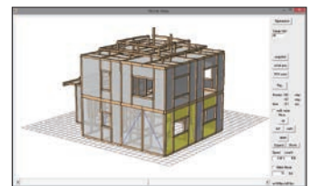
STRDESIGNの計算結果を wallstatで表示した例
