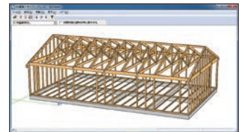
トラス屋根構造を持つ建物構造の表示例 (3次元可視化ツールによる表示)
