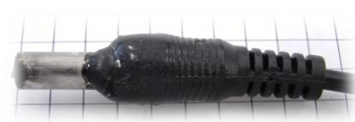
発熱して変形したDCプラグ (赤リントラブル)
