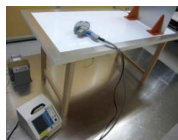
静電気印加設備
