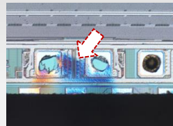
絶縁層間層（PSG層）の剥離
