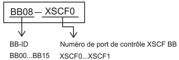
Figure 4-11 Exemples de présentation d'une étiquette de câble XSCF (côté du boîtier à barre transversale)
