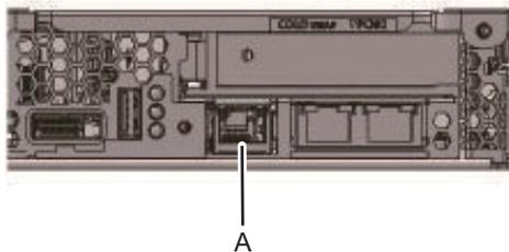
2. **Conecte el cable LAN de Categoría 6 o superior de un puerto 10 GbE (A en [Figura 4-2](#)) al switch de red o hub.**
