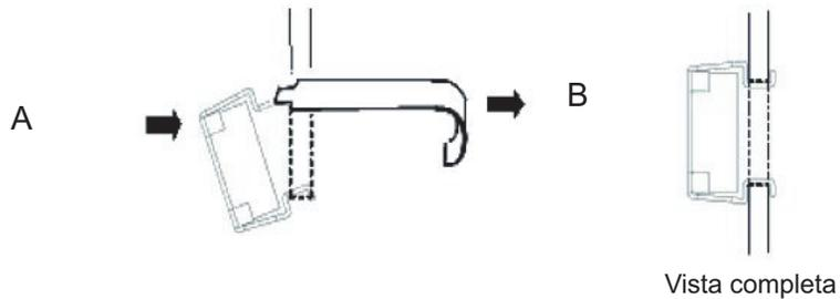
▪ **Para columnas de apoyo con orificios para tornillos M6**
