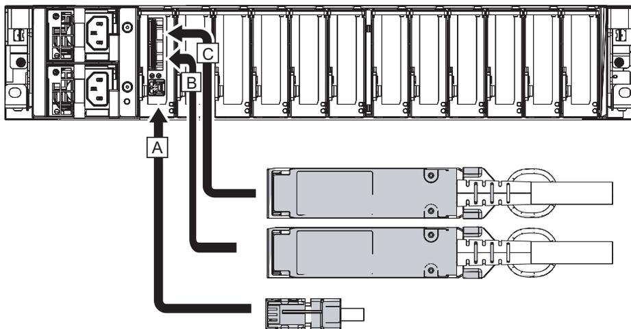
Figura 4-6 Conexión de los cables de enlace y del cable de gestión (SPARC M12-1)
