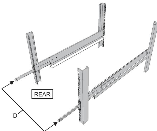
Figura 3-23 Cómo asegurar una abrazadera de fijación del soporte para cables y la guía
