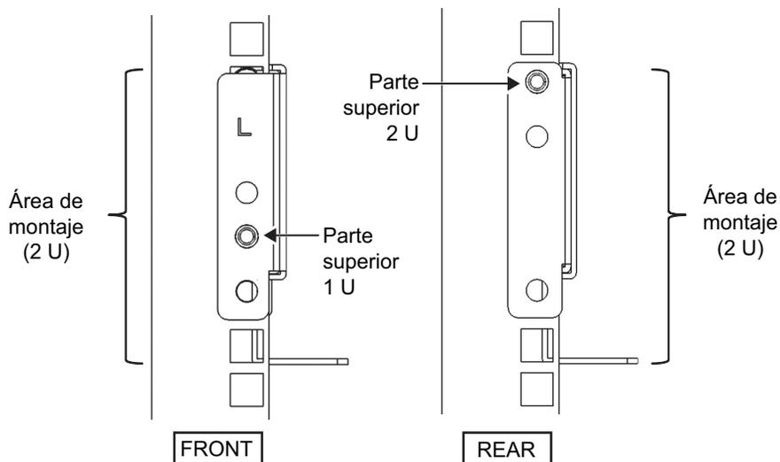
Figura 3-19 Conexión de la guía: punto de fijación del tornillo
