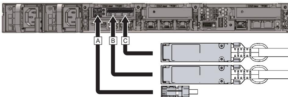
3. **Si se monta una tarjeta PCIe, conecte el cable LAN y el cable de E/S a cada uno de los respectivos puertos de la tarjeta PCIe.**
