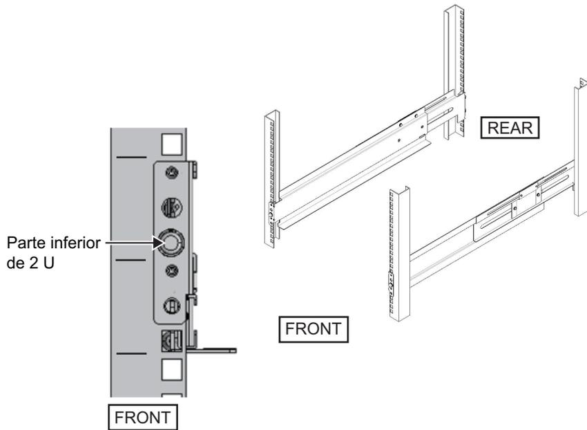
6. **Conecte las abrazaderas de fijación del soporte para cables a las columnas de apoyo posteriores del bastidor.**
