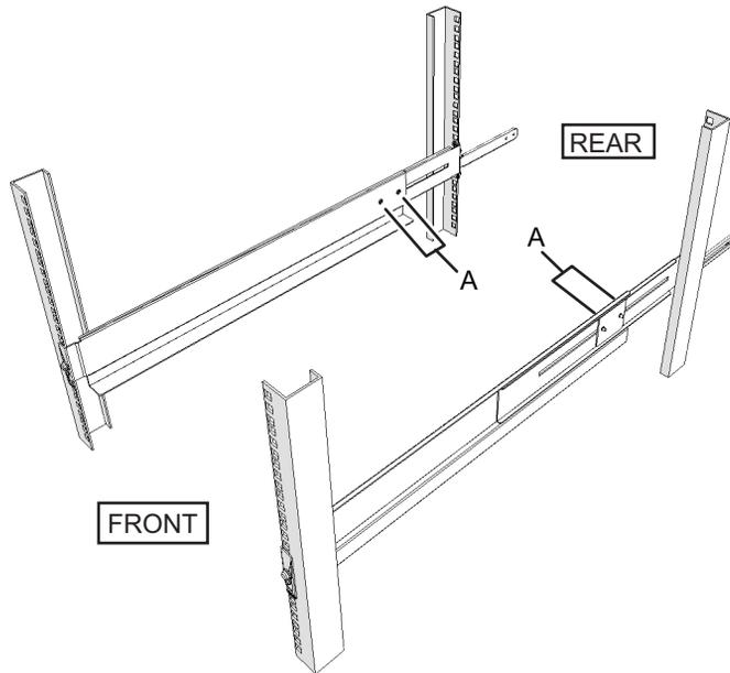
8. **Monte la unidad de expansión PCI en el bastidor.**
